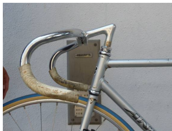
〈図10〉ルールに抵触しないようにステムを引き上げる
