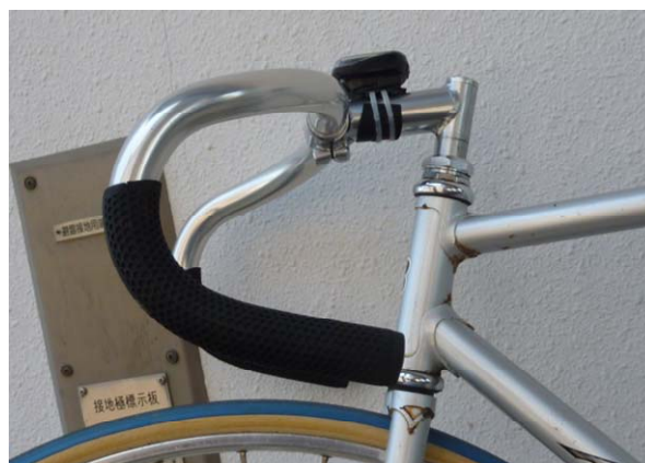
〈図12〉ハンドルとステムを交換した例。 また、レース中では見える位置にスピードメータ等の装着は不可
